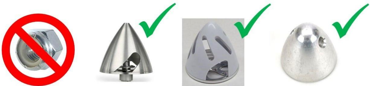
Figura 2-2 – Conos de Hélice y tuerca de seguridad
